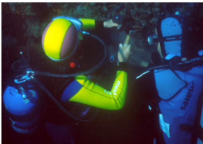
Fig. 6 - Esecuzione di un campionamento su una parete rocciosa tramite grattaggio con martello e scalpello (notare il paramano di gomma su quest'ultimo); il materiale staccato dalla roccia viene fatto cadere in un sacchetto di polietilene.
